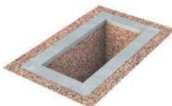
Figure 6. Semelle en béton préfabriquée ou coulée en place sur le bon sol
