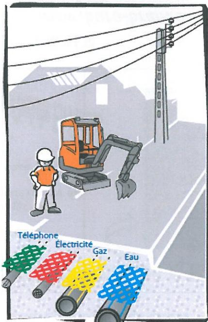
Le sous-sol est de plus en plus encombré par les réseaux souterrains (eau, assainissement, électricité, gaz, télécommunications, câbles ...).
