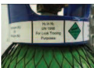
Un mélange d'hydrogène ou d'hélium avec l'azote peut permettre de trouver la fuite à une pression plus faible. Un détecteur de fuite approprié doit être utilisé – votre détecteur habituel n'est pas sensible à l'hydrogène ou l'hélium. L'azote peut être fourni avec des traces
