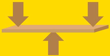
Mise sous contrainte mécanique effectuée par la machine de classement afin de déterminer la classification de chaque planche.
