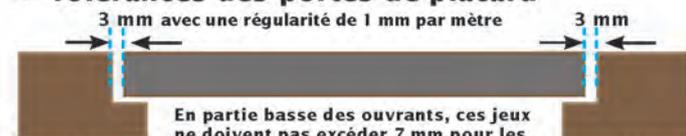
En partie basse des ouvrants, ces jeux ne doivent pas excéder 7 mm pour les portes ouvrant sur le sol, 3 mm pour les façades de placard comportant une traverse basse, avec régularité de 1 mm par mètre. Des portes de placards particulières telles que les portes pliantes peuvent nécessiter des jeux de fonctionnement plus importants.
