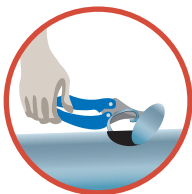
1 Traçage et découpage du trou
