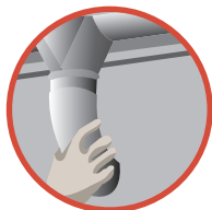
2 Mise en place d'un coude
