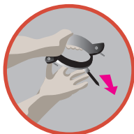
5 Repérage et fixation des colliers
