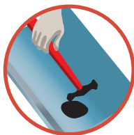
2 Façonnage du collet battu
