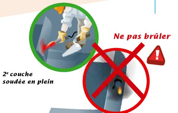
*Les joints de recouvrement de la 2<sup>e</sup> couche doivent être décalés par rapport à ceux de la 1<sup>e</sup> couche*
