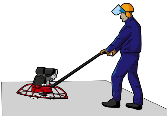
Truelle mécanique — Possibilité de talochage manuel.
