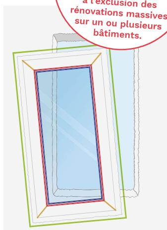
— mastic de calfeutrement (jonction mur/dormant)
