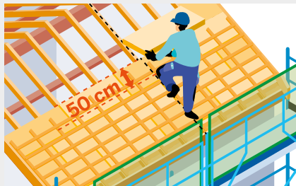
▲ Toiture de pentes « courantes » : positionnement à 50 cm minimum en contrebas du bord côté vide du dernier rang posé – Moyens de protection collective ou individuelle non représentés.
