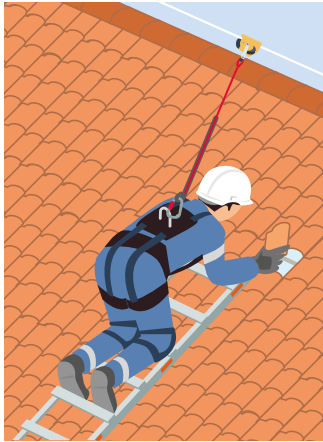
◀ Système d'arrêt de chute sur ligne de vie horizontale (b).
