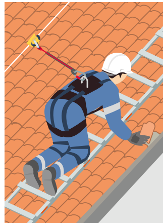
Système de retenue sur ligne de vie verticale (a). ►
