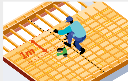
▲ Toiture de pente inférieure à 10° : positionnement à 1 mètre en contrebas du bord côté vide du dernier rang posé – Moyens de protection collective ou individuelle non représentés.
