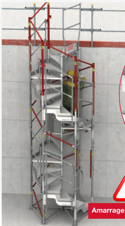
12 - Pose des 2 amarrages sous le dernier module 2 marches. Si la hauteur d'accès est supérieure à 4m90, prévoir 2 amarrages supplémentaires à mi-hauteur.
