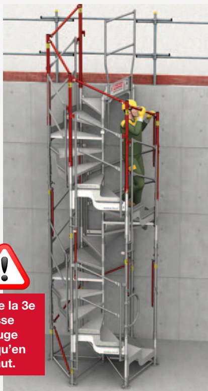
11 - Pose de 5 poteaux rouges de fermeture 5. En redescendant, mise en place de toutes les 3e lisses rouges (sauf entrées) et du garde-corps d'entrée B 6
