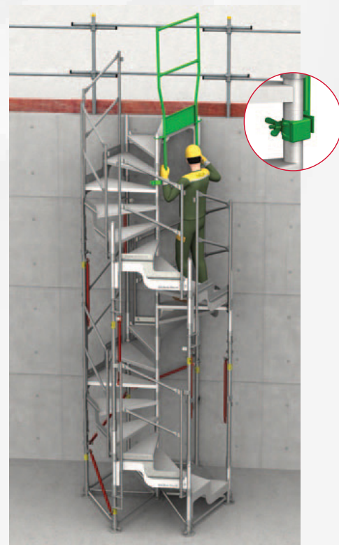
10 - Pose d'un garde-corps de fermeture 4. Serrer fermement les 2 colliers.
