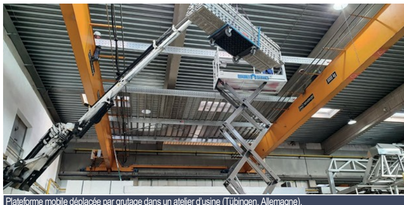
Plateforme mobile déplacée par grutage dans un atelier d'usine (Tübingen, Allemagne).
