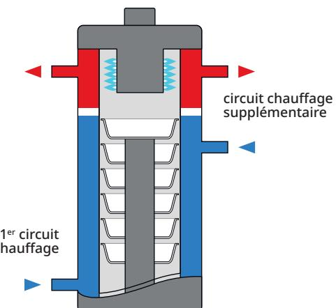
La partie basse du corps de chauffe (zone la plus froide) optimise la condensation et la prolonge, même lorsque les grands froids apparaissent et que la température du chauffage augmente.
