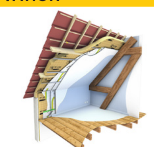
Isolation de charpente traditionnelle en monocouche
