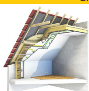
Isolation de charpente traditionnelle
